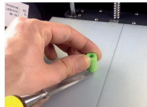
По завершению печати принтер издаст 3 звуковых сигнала. Необходимо воспользоваться функцией «Снятие модели», и аккуратно отделить деталь от пленки с помощью прилагаемых инструментов для снятия детали.
