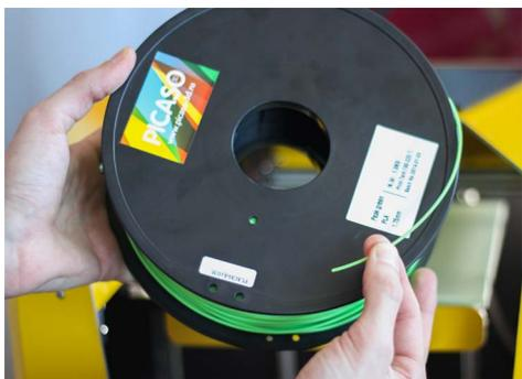
7. Откройте крышку PICASO 3D Designer. Аккуратно возьмите катушку с пластиком и установите ее на держатель катушки. Протолкните пластик по трубке пока он не появится из конца трубки у печатающей головки.
