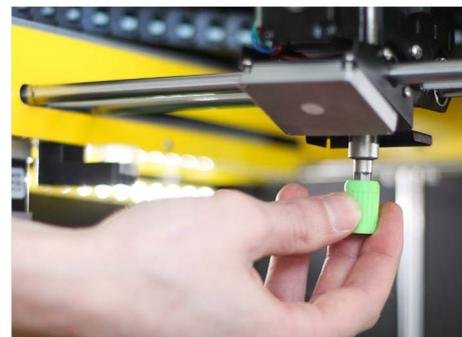
2. Поверните ключ против часовой стрелки, чтобы открутить старое сопло.
