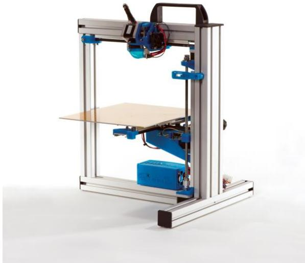
Еще одна схема, которая применяется в 3D принтерах. Последнее время она постепенно сходит на нет, ввиду отсутствия каких-либо преимуществ, перед другими. Это схема X-Head YZ-Bed. В принципе, это очень похоже на предыдущий вариант, только здесь у нас двигается не экструдер верх-низ, а сам рабочий стол. Кроме движения по вертикали, стол также перемещается по оси Y.
