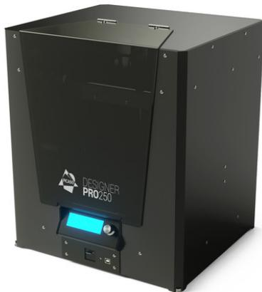
Сейчас принтеры используют корпуса из фанеры или из металла, которые являются несущими. Последнее время, мы наблюдаем варианты, когда используется металлический каркас максимально жесткой конструкции, на которого навешиваются декоративные панели. Это позволяет избежать вибраций и максимально точно перемещать экструдер в нужную точку. Точность позиционирования - это один главных из главных факторов качественной печати.
