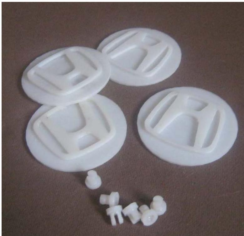
На фото – наклейки на диски для Honda HRV и детальки крепления этих накладок. Основную деталь заказчик делал из стеклоткани, из эпоксидки, а именно сами эмблемы, значки делались на моем принтере.
