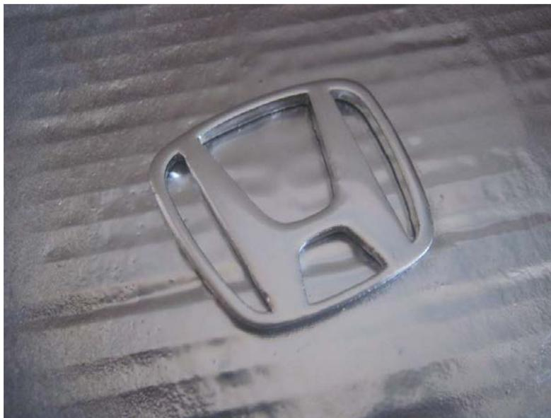
Вот еще деталь с покрытием «хром». Изготавливается на 3D-принтере и сверху брызгаем из баллончика, купленного в автомагазине. ***Это для декоративных деталей, не для силовых.***
