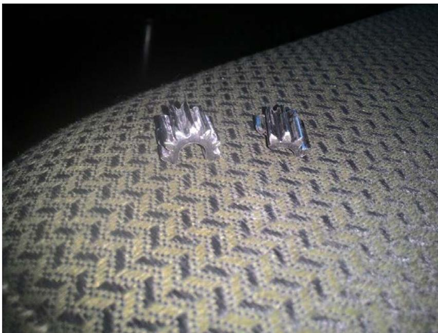
Деталь сломана, но ее можно совместить и измерить размеры. Нас в данном случае интересует только количество зубьев. Их размеры и размеры самой шестерни.
