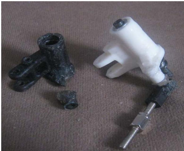
Например, на фото рычаг управления для радиомодели машины, которая сломалась. Ее пытались клеить эпоксидкой, и деталь вновь отламывалась. В итоге была сделана заново на 3D-принтере. Изготовить модель не сложно – измеряем штангенциркулем. Единственный нюанс – надо осторожно относиться к приему заказов, есть бензиновые машинки,
