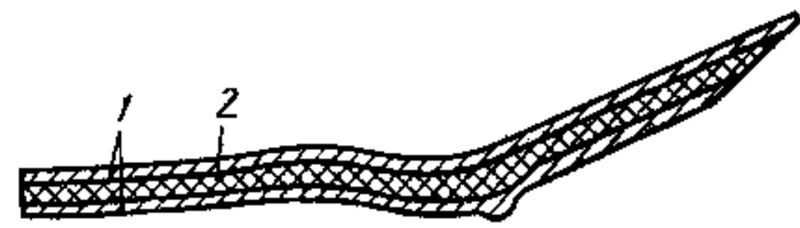
Рис. 1.9. Изделие, отлитое из двух различных полимеров
