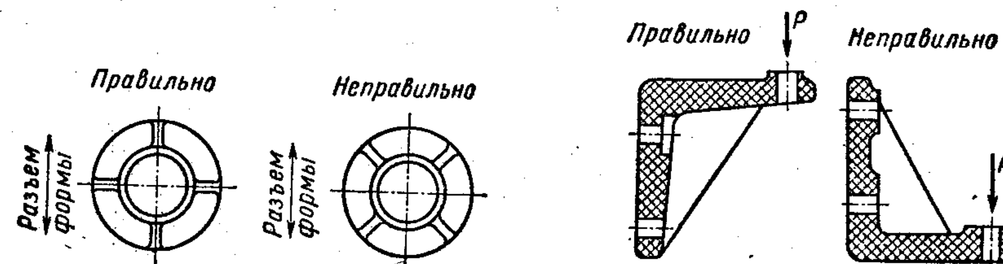
Рис. 40. Расположение ребер жесткости с учетом плоскости разъема пресс-формы
